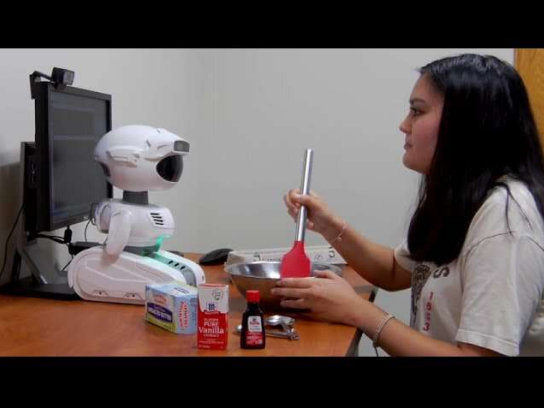
Robot, kurabiyeleri pişirmeye hazırlanırken kullanıcıya ne zaman yardım edeceğini belirlemek için kullanıcının bakışlarını ve konuşmasını izler.
